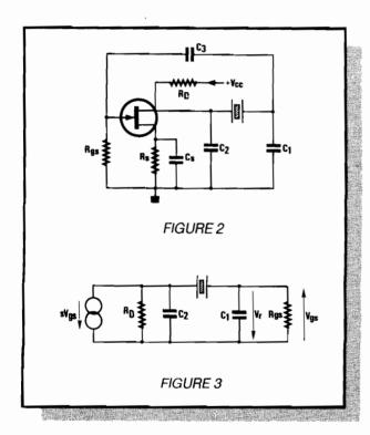
Le schéma équivalent fait l'objet de la figure 3 ; le découplage de la source a été considéré comme parfait, de même que l'impédance du condensateur C<sub>3</sub> a été supposée négligeable à toutes les fréquences. Ce schéma peut se simplifier en posant :
