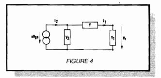
La condition d'oscillation s'écrit  $T=V_r/V_{gs}=-1$  d'où, à partir de la relation précédente :
